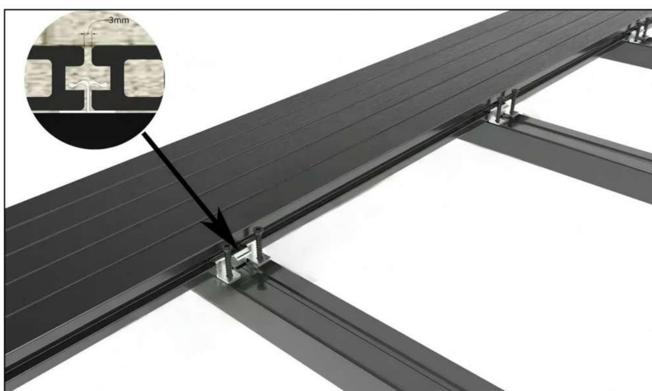
Rys. 11. Zamontowanie klipsów montażowych ze stali nierdzewnej
