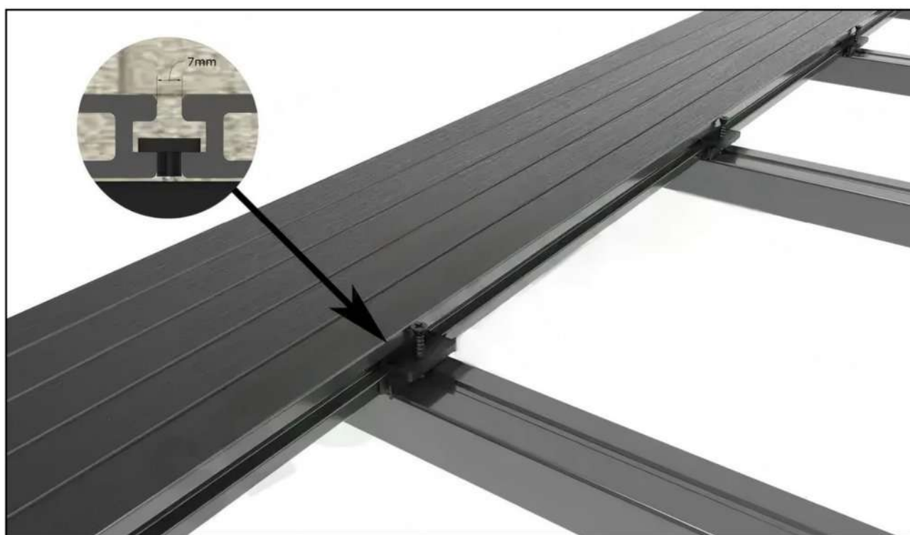
Rys. 10. Zamontowanie klipsów montażowych plastikowych
